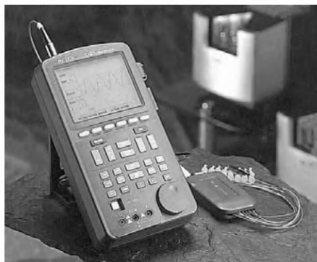
Рис. 3.59. Внешний вид комбинированного прибора DG SCOPE
