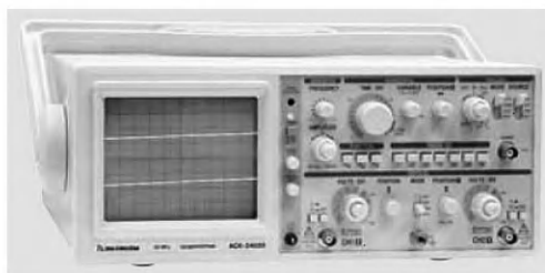
Рис. 2.28. Аналоговый осциллограф АСК-24020 с встроенным функциональным генератором
