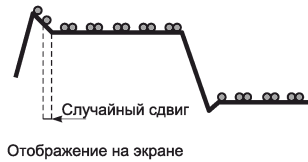
Рис. 5.60. К дискретизации со случайным выбором отсчетов
