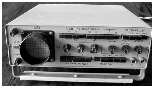
Рис. 2.2. Осциллограф для радиолюбителей Н313
