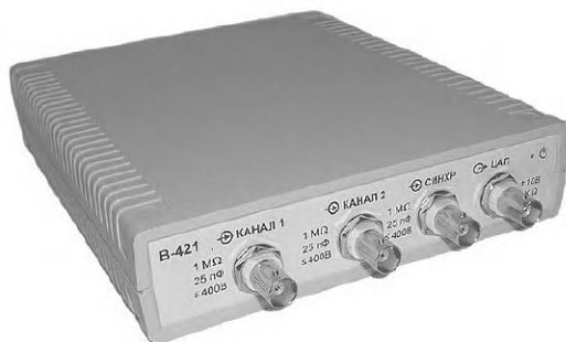
Рис. 4.28. Двухканальный цифровой осциллограф BORDO-421
