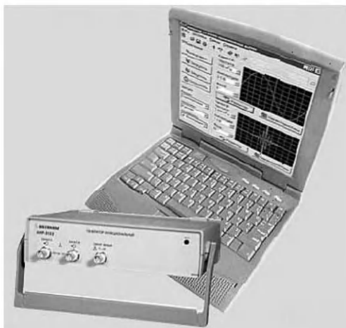
Рис. 4.40. Приставка — функциональный генератор АНР-3121/3122
