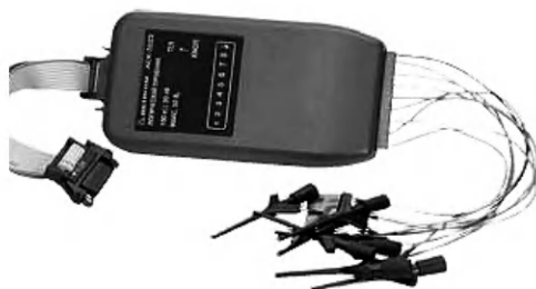
Рис. 3.24. Блок логического анализатора для осциллографа АСК-2023
