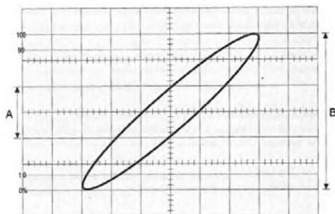
Рис. 5.25. К измерению фазового сдвига двух синусоидальных сигналов
