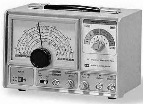
Рис. 5.14. Генератор синусоидальных сигналов GRG-450B фирмы Good Will
