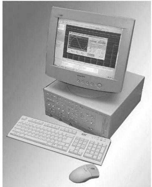
Рис. 3.14. Цифровой осциллограф С8-40
