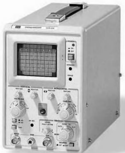
Рис. 2.15. Универсальный малогабаритный осциллограф GOS-310
