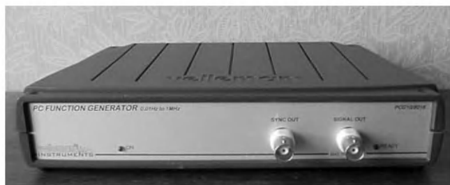
Рис. 4.8. Приставка — функциональный генератор PCG10 (вид спереди)
