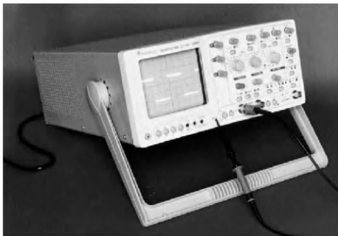
Рис. 2.9. Сервисный универсальный осциллограф С1-160
