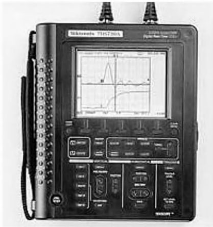
Рис. 3.60. Внешний вид портативного осциллографа THS370A
