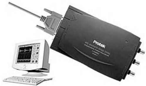
Рис. 4.35. Приставка-осциллограф DSO-2100
