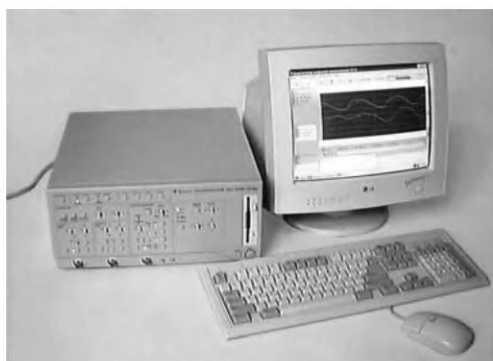
Рис. 3.13. Цифровой осциллограф С8-37
