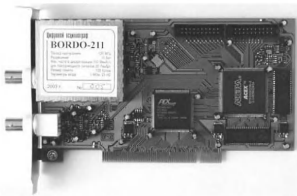
Рис. 4.31. PCI плата одноканального 120-мегагерцевого осциллографа B-211
