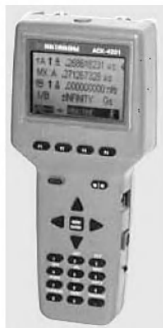
Рис. 3.40. Портативный цифровой измеритель — мультископ АСК-4201
