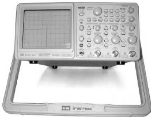
Рис. 3.11. Внешний вид аналогово-цифровых осциллографов GOS 6031
