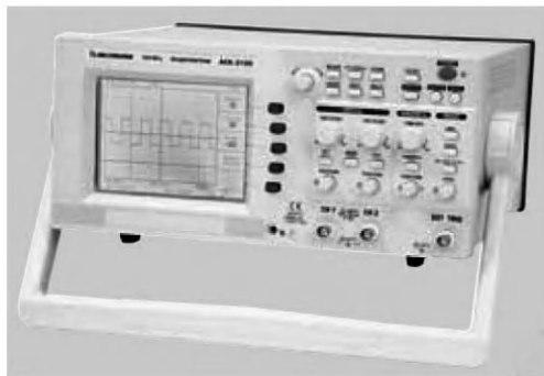
Рис. 3.19. Цифровой осциллограф АСК-2150
