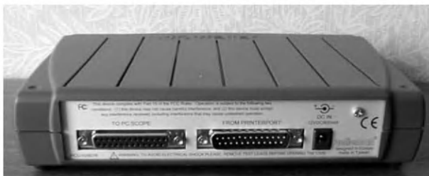
Рис. 4.9. Приставка — функциональный генератор PCG10 (вид сзади)
