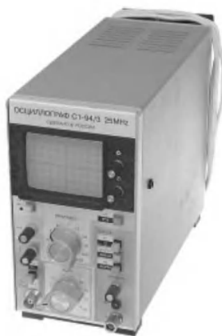
Рис. 2.3. Миниатюрный сервисный осциллограф С1-94/3
